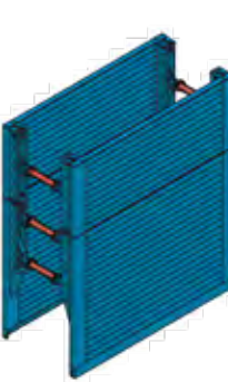
E+S Médian Profondeur de blindage jusqu'à 5,00 m Recommandée : pelle sur pneus ou sur chenilles caisson de base seul : 12-18 t avec caisson de rehausse : 18-30 t Page 160
